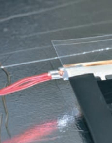
Рис. 17. Вид правильного подключения проводов к термопленке
