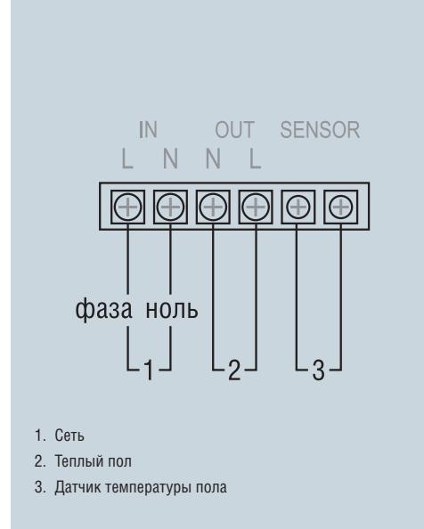
Рис. 20. Пример подключения соединительных проводов к терморегулятору CALEO Model 320
