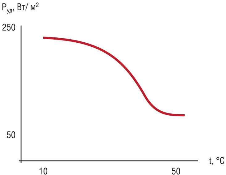
Рис. 1. Зависимость удельной мощности от температуры нагрева
