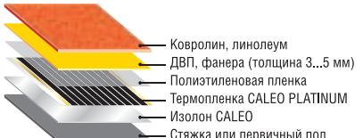
Рис. 28. Схема монтажа пленочного теплого пола под ковролин, линолеум
