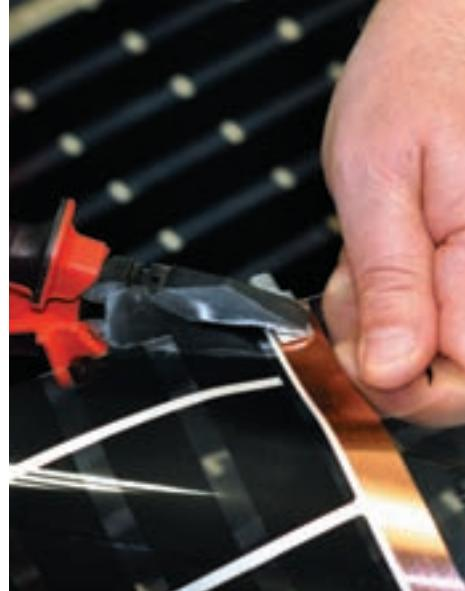
Рис. 10. Крепление контактного зажима к термопленке (обжатие плоскогубцами)
